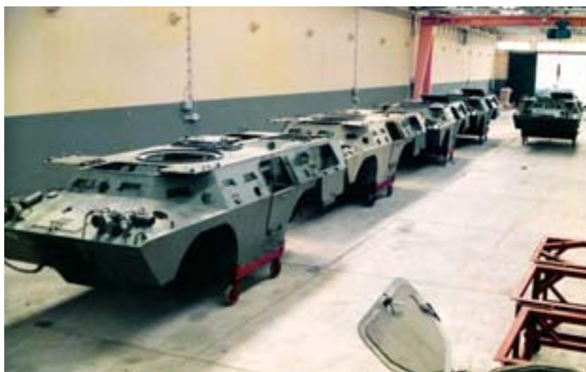
A remotorização das Chaimites, feita nas OGME em Lisboa, abrangeu 81 Chaimites V-200 (Foto OGME)
